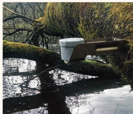
La sonde VEGA sur la frayère de Kerallain sur le Blavet a enregistré le niveau d'eau toutes les 2 heures au printemps 2024
