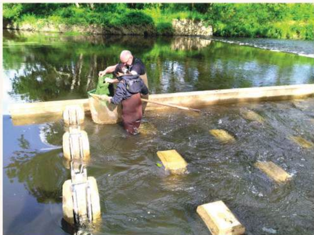
Des « flottangs » sont utilisés pour mesurer l'efficacité des passes à poissons sur les anguillettes
